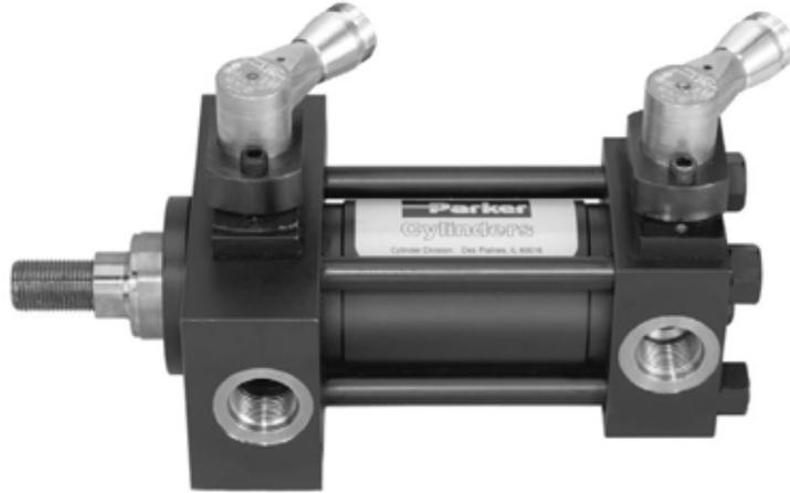
Parker EPS 是电感式接近开关,它既适用于气缸又适用于液压缸,提供活塞杆完全伸出或缩回时的指示。该完全固态电路用环氧树脂封装于壳体内,外型符合下面所列的标准要求。非接触探头检测铁质缓冲柱塞或缓冲套的存在。没有凸轮、柱塞、机械开关或动密封件被磨损或需要调整。通过把EPS接近开关装进缸头或缸盖,消除了与外置行程开关相关的昂贵设计和调整时间。此外,由于探头密封于缸体内,所以该开关不会被无意中损坏。EPS符合UL要求,并被设计成能在电流达20000安培的接触焊机距电机头1英寸的范围内工作。
